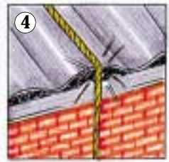
Punto con rischio di taglio / rottura fune di collegamento
